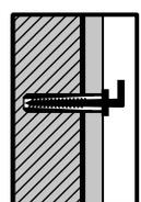
Cuando se instale en habitaciones con mucha humedad (cuartos de baño, etc.), aplique sellador polimérico MS alrededor del borde del orificio para garantizar un sellado estanco duradero.
